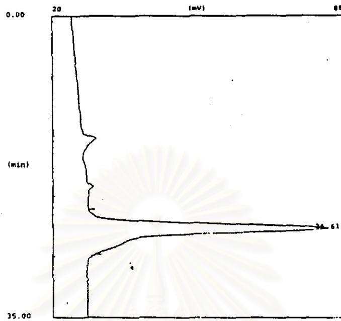
รูปที่ 35 แสดงโครมาโตแกรมของเอกโซพอลิแซคคาไรด์ที่ผลิตโดยเชื้อ AP-1 จากการวิเคราะห์น้ำหนักโมเลกุลด้วยเครื่อง HPSEC
