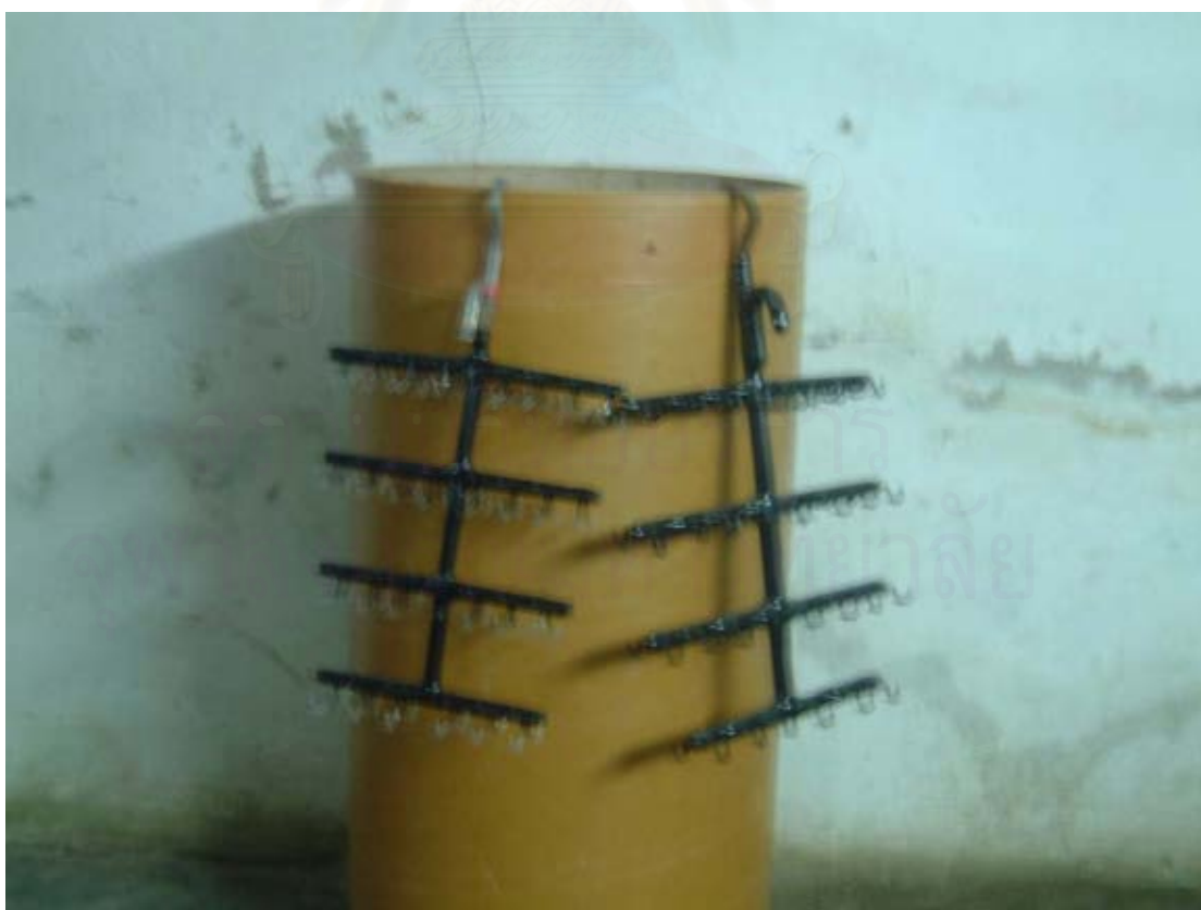
รูปที่ 6.2 จิ๊กแขวนชิ้นงานที่ใช้อยู่และจิ๊กที่สั่งทำใหม่แบบมียางหุ้มสำหรับงานชุบกันหมอง
