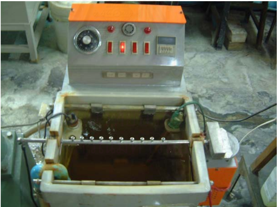
รูปที่ ก-2 ถังน้ำยาชုပ်และอุปกรณ์ควบคุม
