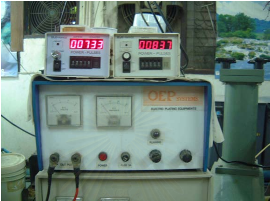
รูปที่ ก-3 เครื่องวัดค่าแอมแปร์·มินิตและแผงควบคุมกระแสไฟฟ้า
