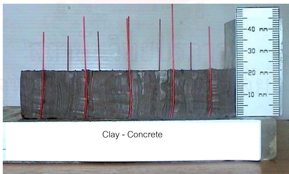
รูปที่ 4.14 ตัวอย่างการงอของแท่งดินสอภายในตัวอย่างดินภายหลังการทดสอบ
