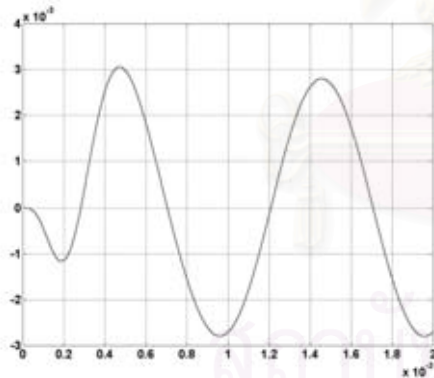
รูปที่ 8 สัญญาณผลต่างขาออกที่ผ่านวงจรกรองผ่านต่ำ
