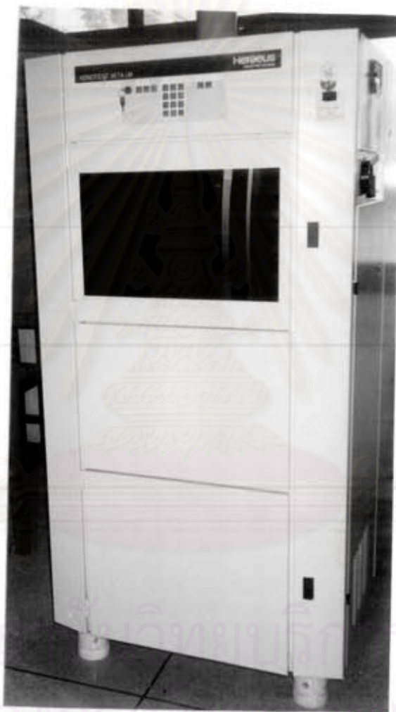
รูปที่ 3.3 เครื่อง Xenotest Beta Lamp สำหรับเร่งแสงอัลตราไวโอเล็ต
