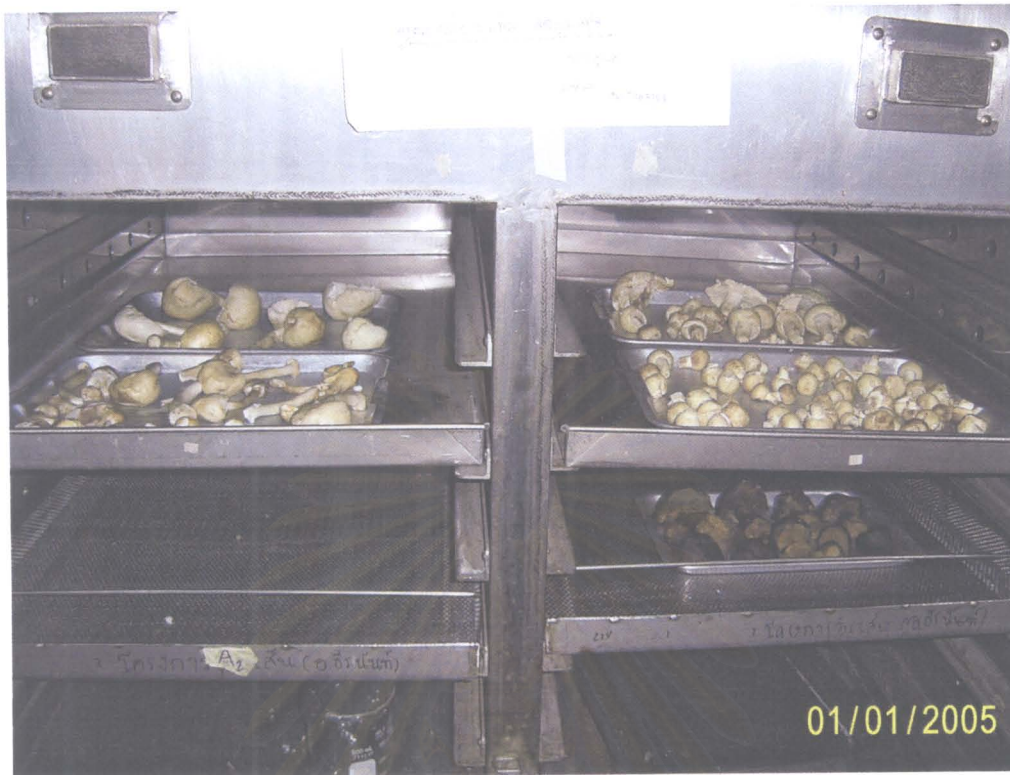
รูปที่ 3 กรรมวิธีในการอบแห้งและเครื่องอบแห้งแบบถาดโดยใช้ลมร้อน
