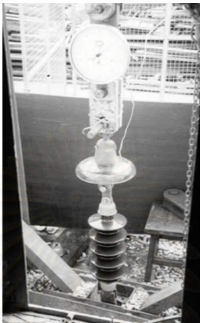
รูปที่ 4.32 การติดตั้งลูกถ้วยฉนวนเพื่อทำการทดสอบหาค่าความแข็งแรงร่วมทางกลและไฟฟ้า
