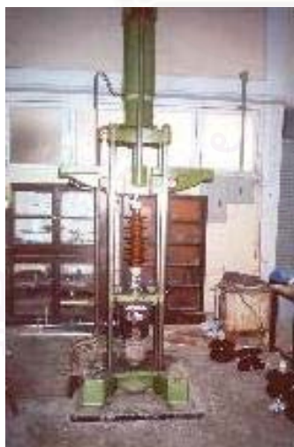
(ก) การติดตั้งลูกถ้วย
