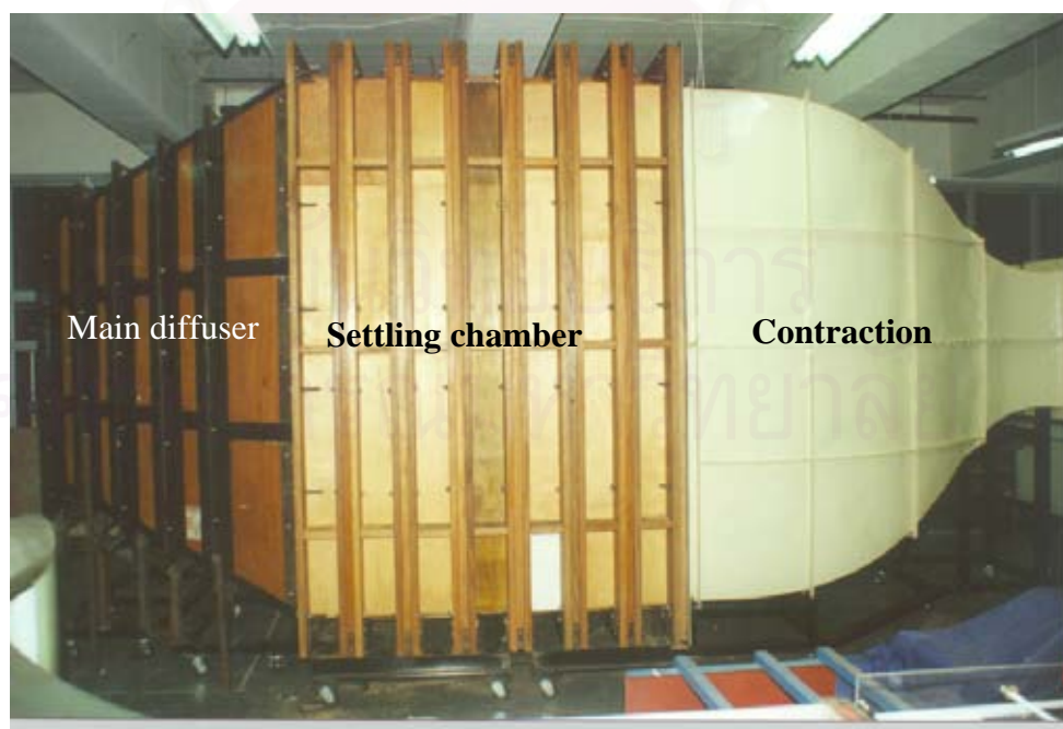
รูปที่ 2.4 ห้องจัดปรับการไหล (Settling chamber) และ Contraction ของอุโมงค์ลม
