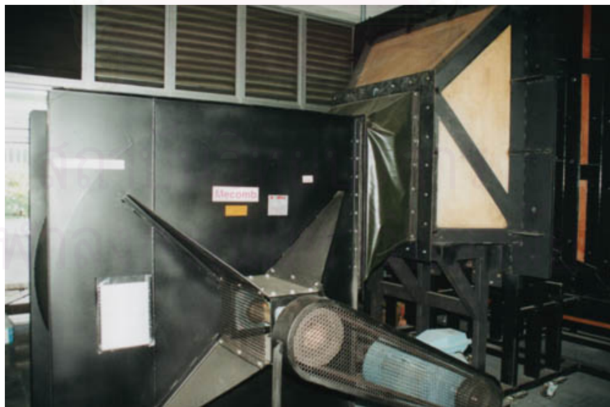
รูปที่ 2.2 พัดลมหยอขัง (Centrifugal Blower) ชนิดใบพัดแบบ Backward-curved airfoil ขนาด 30 กิโลวัตต์ที่ใช้สำหรับอุโมงค์ลม
