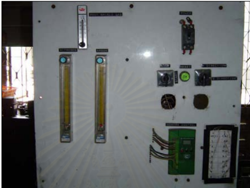
รูปที่ 3.4 ชุดควบคุมอัตราการไหลของแก๊สปกคลุมด้านบนและด้านล่าง
