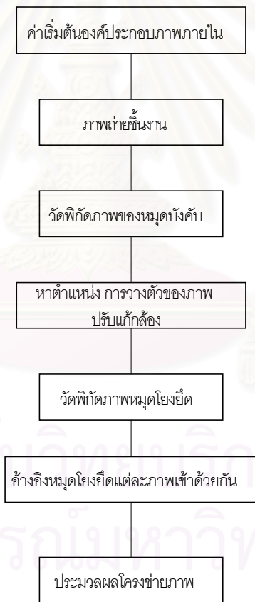
รูปที่ 2.2 แผนผังขั้นตอนแสดงการทำงานการวัดสอบกล้องในตัวด้วยกรรมวิธีแบบทั่วไป
