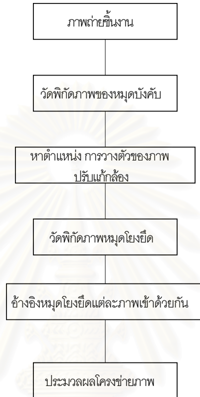
รูปที่ 2.3 แผนผังขั้นตอนแสดงการทำงานการวัดสอบกล้องในตัวด้วยกรรมวิธีแบบอินเวอร์ส
