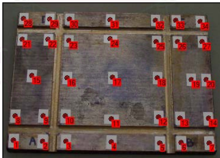
รูปที่ 4.2ค แสดงตำแหน่งหมายเลขจุดบนชิ้นงานทดสอบมาตรฐาน
