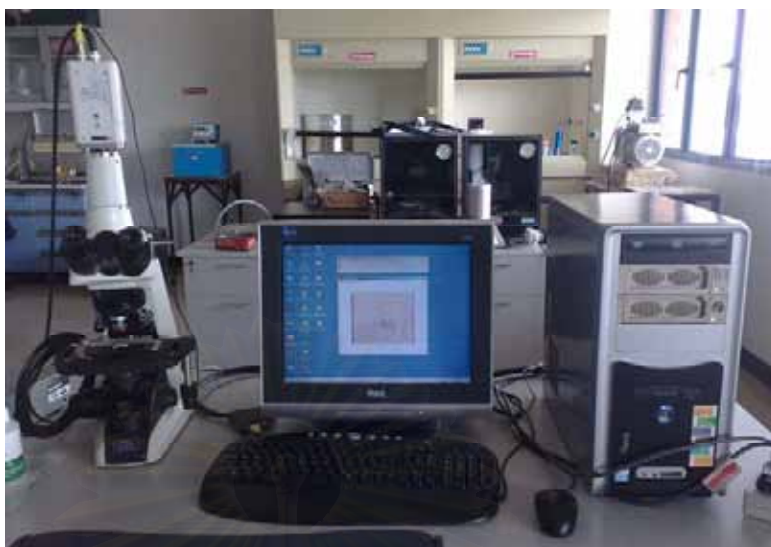
ภาพที่ 3.14 ลักษณะเครื่องนับวัดรอยด้วยโปรแกรมวิเคราะห์ภาพ Image J
