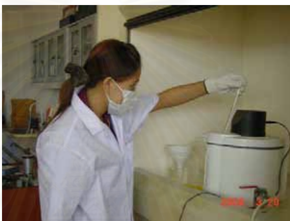
ภาพที่ 3.13 การตรวจวัดอุณหภูมิระหว่างกัดรอยพลาสติก CR-39
