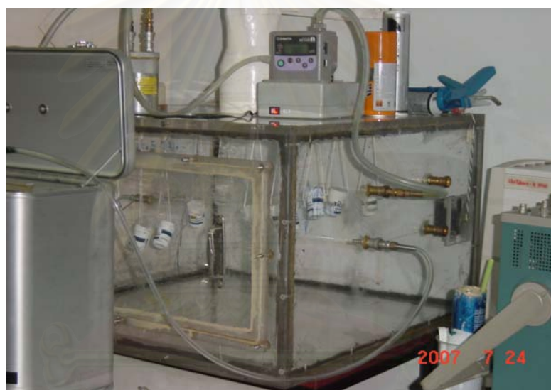
ภาพที่ 4.5 ตู้ปรับเทียบแบบเดิมรูปทรงเหลี่ยมทำจากพลาสติกอะครีลิกใส
