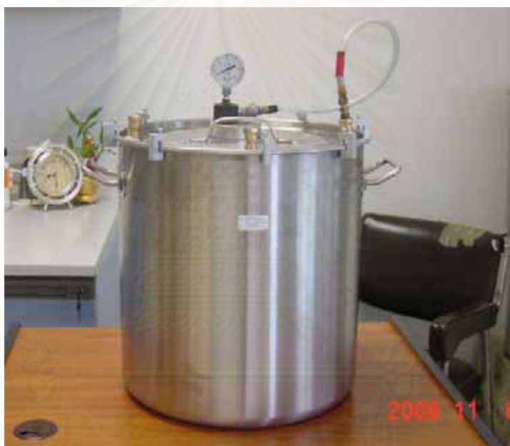
ภาพที่ 3.5 ลักษณะถังวัดก๊าซเรดอนที่ออกแบบสร้างขึ้นใหม่
