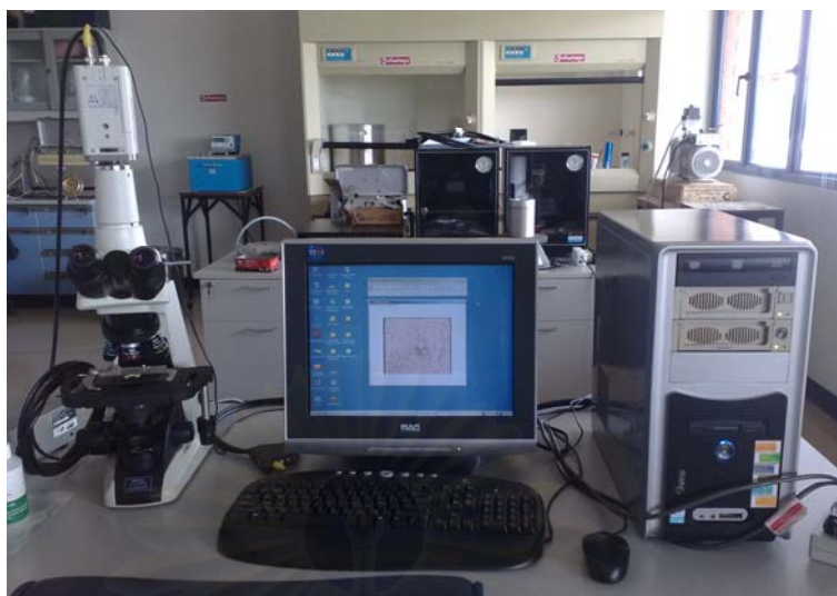
ภาพที่ 4.8 ระบบนับรอยด้วยโปรแกรมวิเคราะห์ภาพ Image J และตรวจสอบด้วยตา
