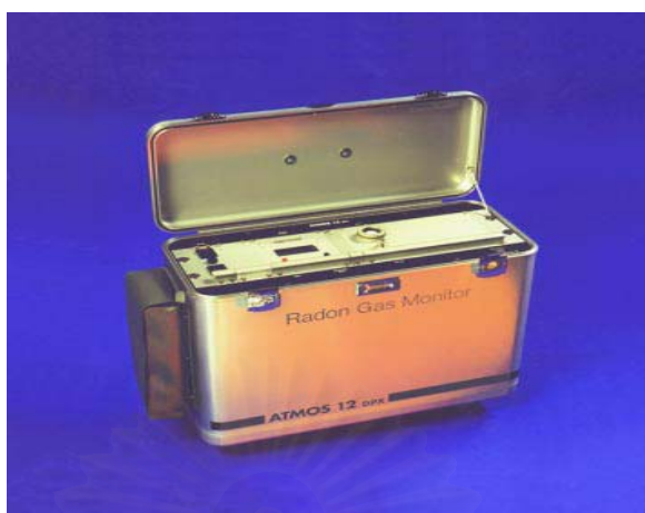
ภาพที่ 4.6 เครื่อง Pulse-counting ionization chamber radon gas monitor ATMOS 12 dpx
