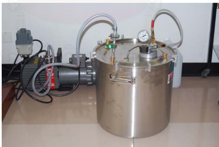
ภาพที่ 4.4 ถังปรับเทียบที่ออกแบบสร้างขึ้นใหม่รูปทรงกระบอกทำจากเหล็กไร้สนิม sus 304
