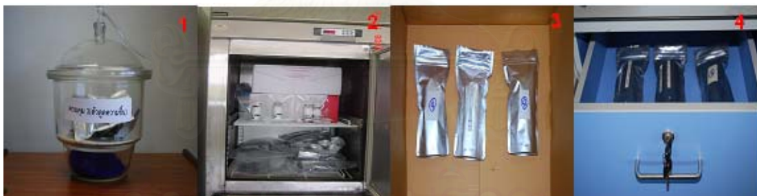
ภาพที่ 4.1 การเก็บรักษาแผ่นพลาสติก CR-39 ด้วยวิธีต่างๆ
