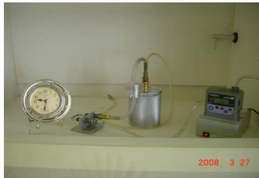
ภาพที่ 3.10 การไล่อากาศเรดอนออกจากต้นกำเนิด
