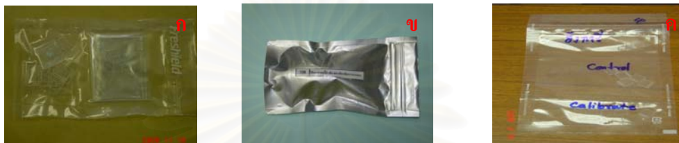
ภาพที่ 3.3 วิธีการเก็บรักษาแผ่นพลาสติก CR-39 หลังจากรับเรดอน
