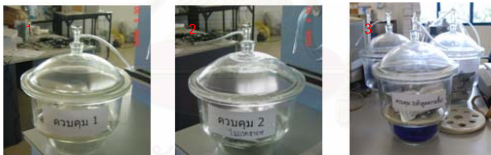
ภาพที่ 4.2 วิธีการเก็บรักษาชุดดัดควบคุมการวัดโดยวิธีเก็บในโถดูดความชื้นแบบต่าง ๆ
