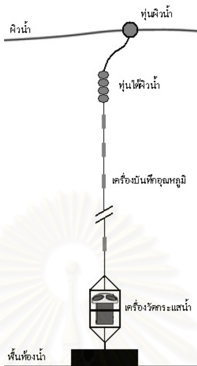
รูปที่ 3.2 ลักษณะการติดตั้งเครื่องวัดกระแสและเครื่องบันทึกอุณหภูมิจากทุ่น
