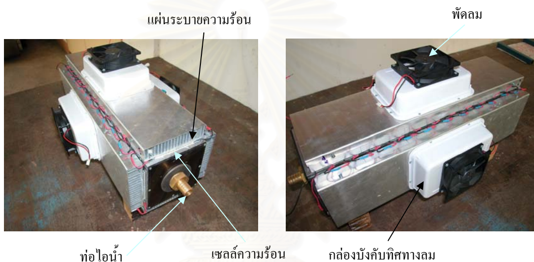
รูปที่ 3.14 โมดูลเซลล์ความร้อนขนาด 200 V DC, 12.5 W ที่พัฒนาขึ้น
