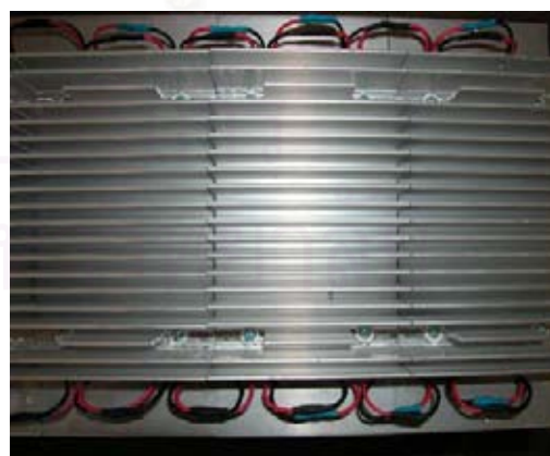
รูปที่ 3.12 แบบโครงสร้างส่วนประกอบของโมดูลเซลล์ความร้อนที่พัฒนาขึ้น
