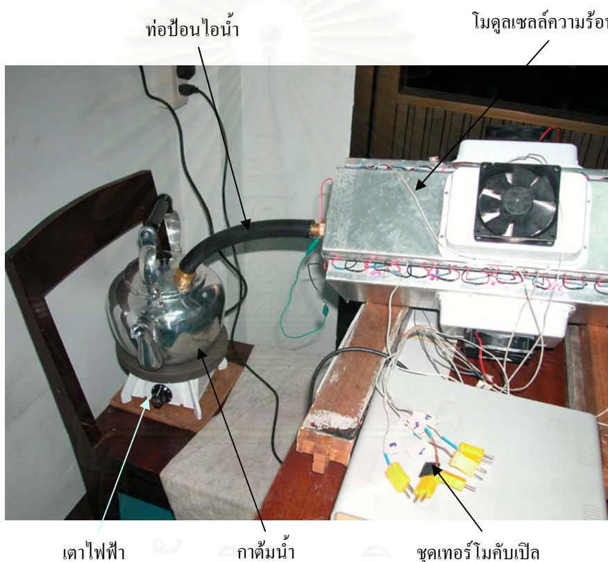
รูปที่ 3.15 การผลิตไอน้ำด้วยเตาไฟฟ้าต้มน้ำแทนความร้อนเหลือทิ้ง
