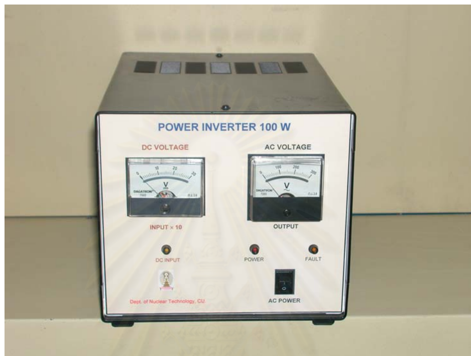
รูปที่ 3.19 เครื่องแปลงไฟฟ้ากระแสตรงเป็นไฟฟ้ากระแสสลับ 220 โวลต์ 50 เฮิร์ตซ์ ขนาดกำลัง 100 วัตต์
