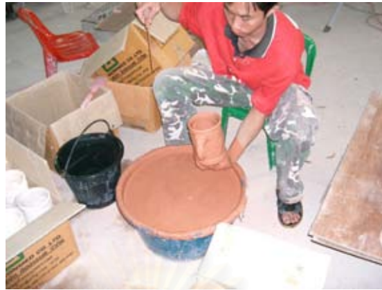
รูปที่ 4.12 ชุบเคลือบโดยวิธีการจุ่ม
