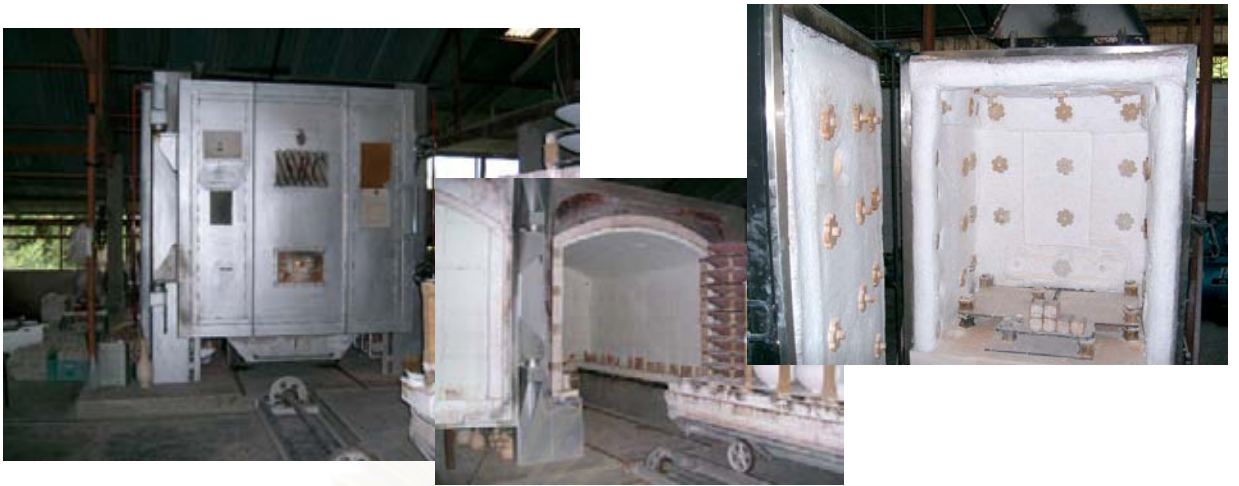
รูปที่ 4.7 เตาเผา ประเภทเตาแก๊สบูด้วยอิฐทนไฟหรือไฟเบอร์
