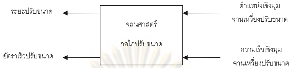
รูปที่ 7.4 การแปลงมุมของงานเหียงปรับขนาดเป็นระยะปรับขนาด
