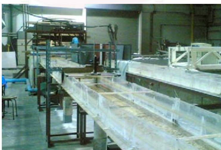
รูป 3.4 (ต่อ) รายละเอียดแบบจำลองชลศาสตร์ การไหลลดประตู่ระบายภายใต้อิทธิพลของน้ำขึ้นน้ำลง
