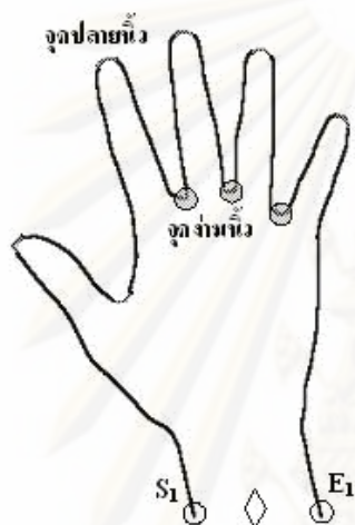
รูปที่ 3.6 การหาตำแหน่งจุดปลายนิ้วและง่ามนิ้ว
