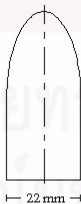
รูปที่ 3.1 ทิศทางที่ใช้ในการตัดโฟมอะลูมิเนียมเพื่อตรวจสอบโครงสร้างมหภาค
