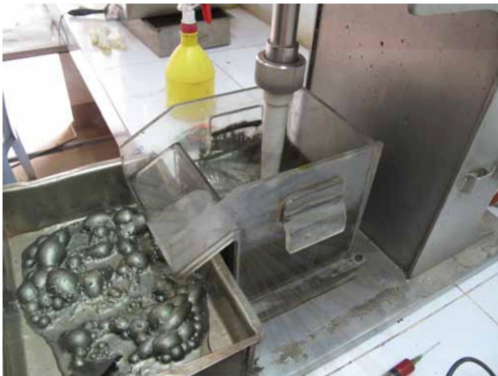
รูปที่ 5.10 แสดงหัวแร่ทองแดงซัลไฟด์ที่ลอยขึ้นมา
