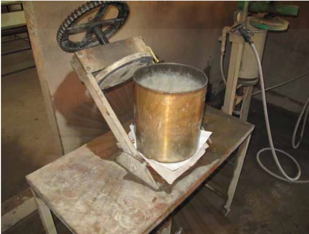
รูปที่ 5.11 แสดง Filter Press ที่ใช้ในการทดลอง
