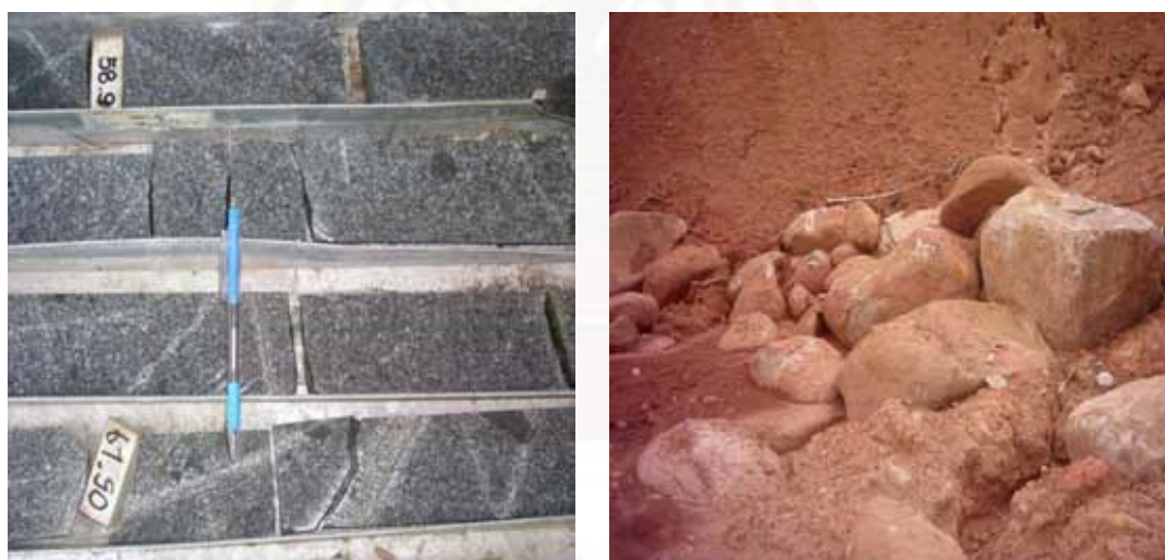
รูปที่ 3.5 แสดงหินแกรนิตไดโอรไรต์ที่พบในหลุมเจาะสำรวจ TDH 109 และหินแกรนิตไดโอรไรต์ที่ผ่านการผุพัง (ทุ่งคำ, 2550)
