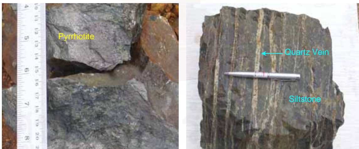
รูปที่ 3.12 แสดงลักษณะของหิน Pyrrhotite skarn (ซ้าย) และสายแร่ควอตซ์ (Quartz vein) ที่แทรกตัดอยู่ในหินทรายแป้ง (ขวา) (ทุ่งคำ, 2550)
