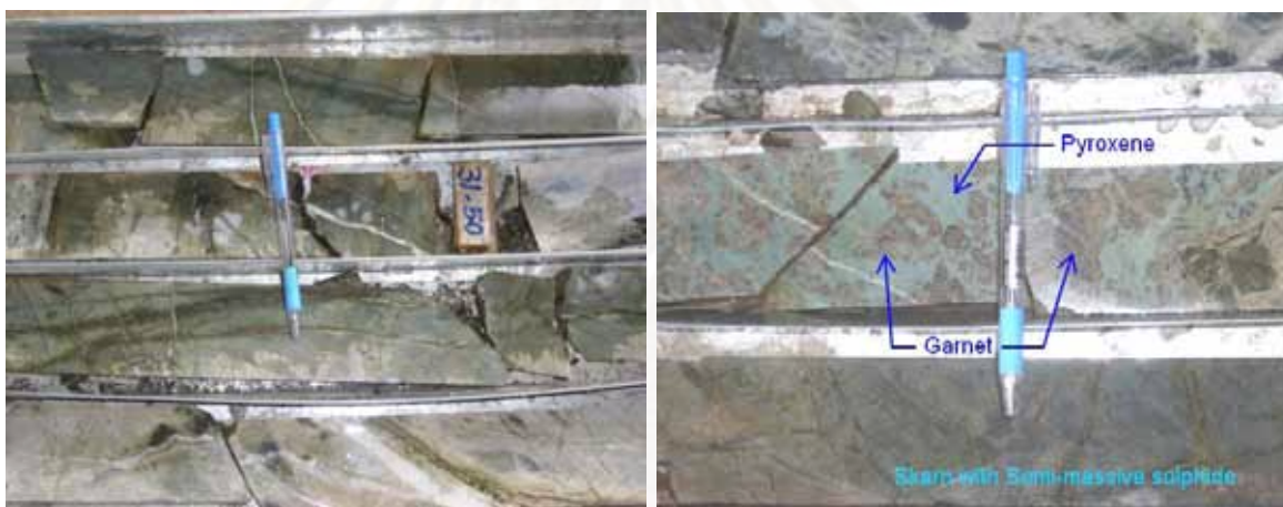
รูปที่ 3.7 แสดงลักษณะของหินสการ์นชนิดเนื้อละเอียดในหลุมเจาะสำรวจ TDH 27 (ซ้าย) และแสดงผลึกการ์เนตที่เกิดร่วมกับไพรอกซีนในหลุมเจาะสำรวจ TDH 20 (ขวา) (ทุ่งคำ, 2550)
