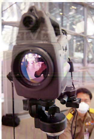
รูปที่ 35 เครื่องเทอร์โมสแกนสำหรับตรวจวัดอุณหภูมิ
