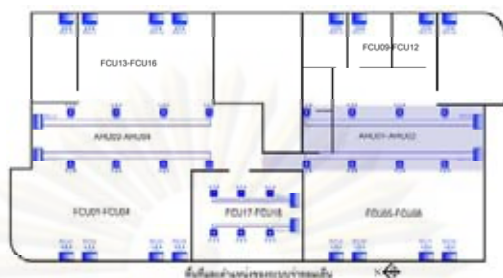
ภาพที่ 4-43 แสดงพื้นที่ทำความเย็นของหัวจ่ายลมเย็น AHU 01-AHU 02 หลังการปรับปรุงอาคารระยะที่ 1 (เดือนธันวาคม 2551)
