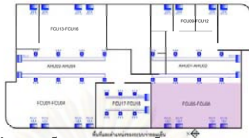
ภาพที่ 4-38 แสดงพื้นที่ทำความเย็นของหัวจ่ายลมเย็น FCU 05-FCU 08 หลังการปรับปรุงอาคารระยะที่ 1 (เดือนธันวาคม 2551)
