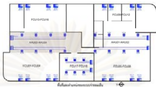
ภาพที่ 4-44 แสดงพื้นที่ทำความเย็นของหัวจ่ายลมเย็น AHU 03-AHU 04 หลังการปรับปรุงอาคารระยะที่ 1 (เดือนธันวาคม 2551)
