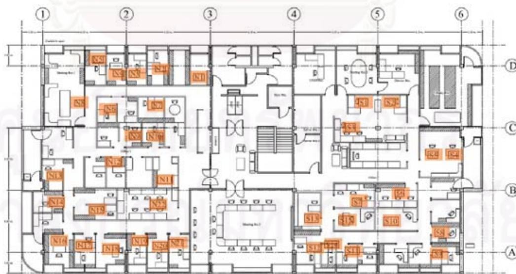
ภาพที่ 4-9 แสดงตำแหน่งที่ทำการตรวจวัดอุณหภูมิ ความชื้นสัมพัทธ์และปริมาณก๊าซคาร์บอนไดออกไซด์ในอาคารกรณีศึกษาส่วนสำนักงานสำนักงาน UNEP
