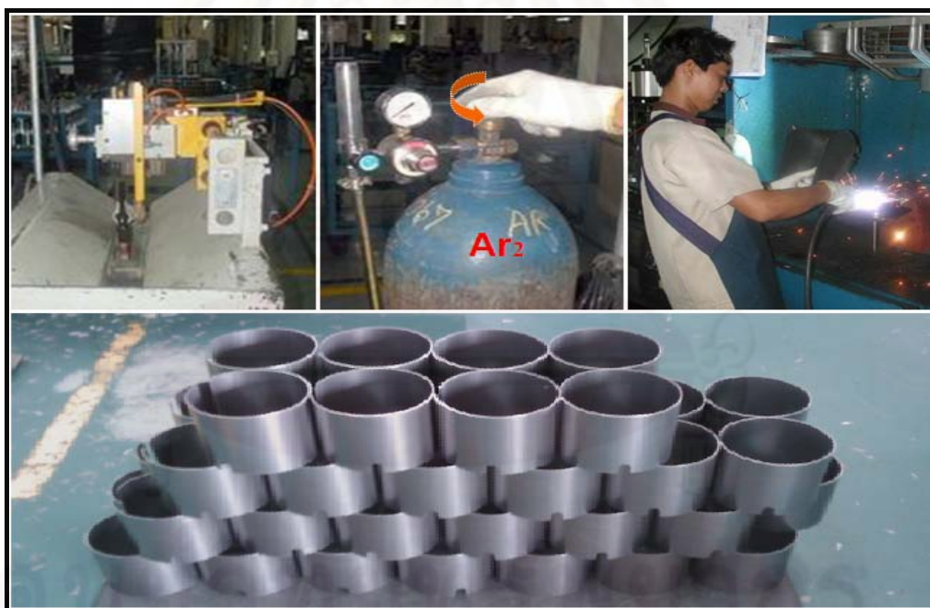
รูปที่ 3.15 กระบวนการม้วนเปลือกมอเตอร์ (ต่อ)
