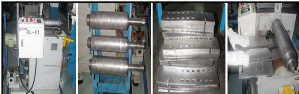
รูปที่ 3.14 กระบวนการม้วนเปลือกมอเตอร์
