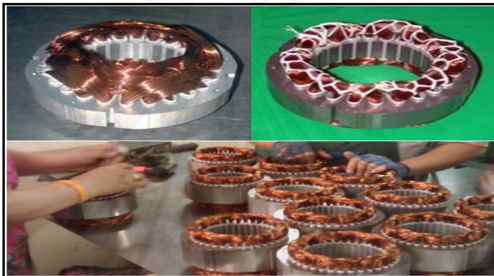
รูปที่ 3.18 กระบวนการพันลวด
