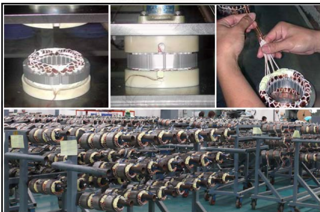
รูปที่ 3.19 กระบวนการพันลวด (ต่อ)
