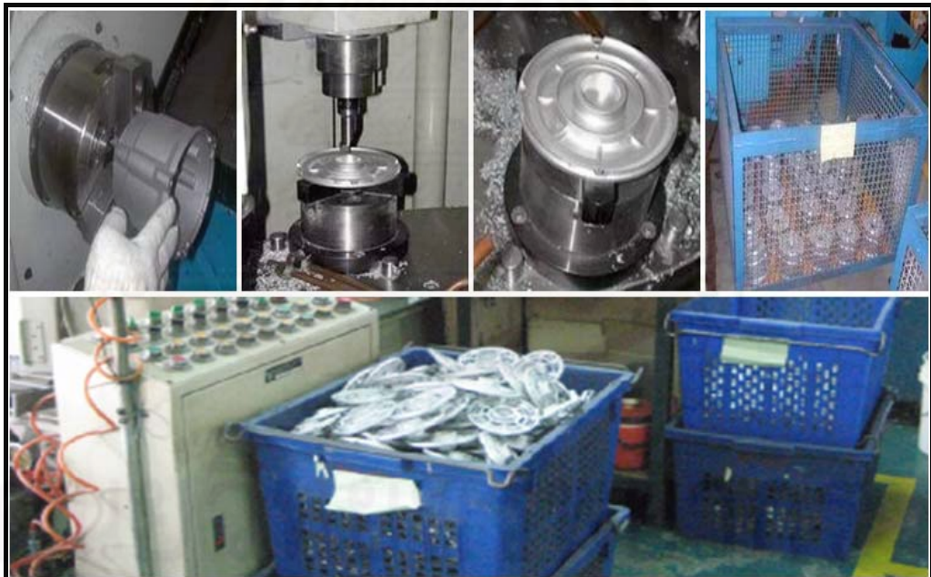
รูปที่ 3.13 กระบวนการกลึงฝามอเตอร์ (ต่อ)
