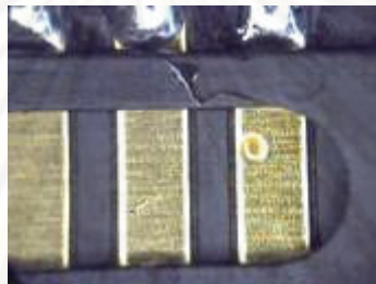
รูปที่ 3.16 การเปื้อนบริเวณ Connector Pad ทำให้ทดสอบค่าทางไฟฟ้าของลูกค้า ไม่ได้
