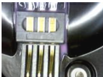
รูปที่ 3.19 กาวไหลเปื้อนเลยขอบด้านล่างของ Connector
