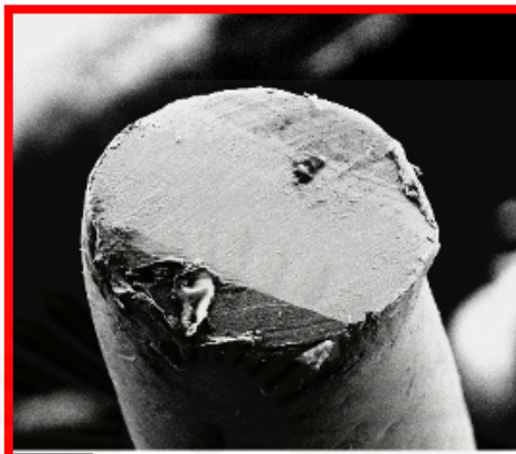
รูปที่ 5.12 รอยขาดของตัวอย่างงานเสียที่เกิดจากสาเหตุแรงเฉือนที่กำลังขยาย 1,000 เท่า
