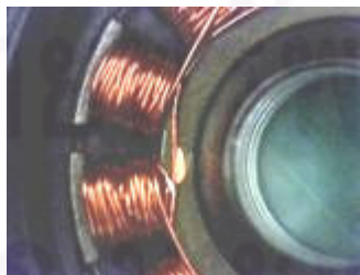
รูปที่ 3.14 เส้นขดลวด Stator เสียหายจากการถูกกด ทับ
