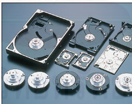
รูปที่ 1.2 ส่วนประกอบหลักในการผลิตฮาร์ดดิสก์หรือสปีนเดิลมอเตอร์
