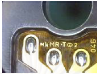
รูปที่ 3.11 การติดแผ่น FPC ไม่สนิทมีฟองอากาศ
