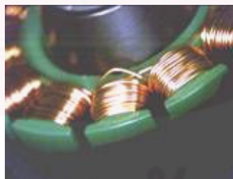
รูปที่ 3.5 เส้นที่พันเป็นขดลวดสเตเตอร์หลวมหรือหลุดออกมาจนขดลวดจนเห็นได้ชัด
