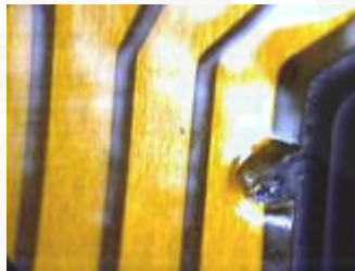
รูปที่ 3.13 แผ่นวงจร FPC เสียหายจากการกด การติด การดึง
