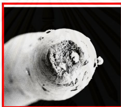
รูปที่ 5.13 รอยขาดของตัวอย่างงานเสียที่เกิดจากสาเหตุแรงดึงที่กำลังขยาย 1,000 เท่า
