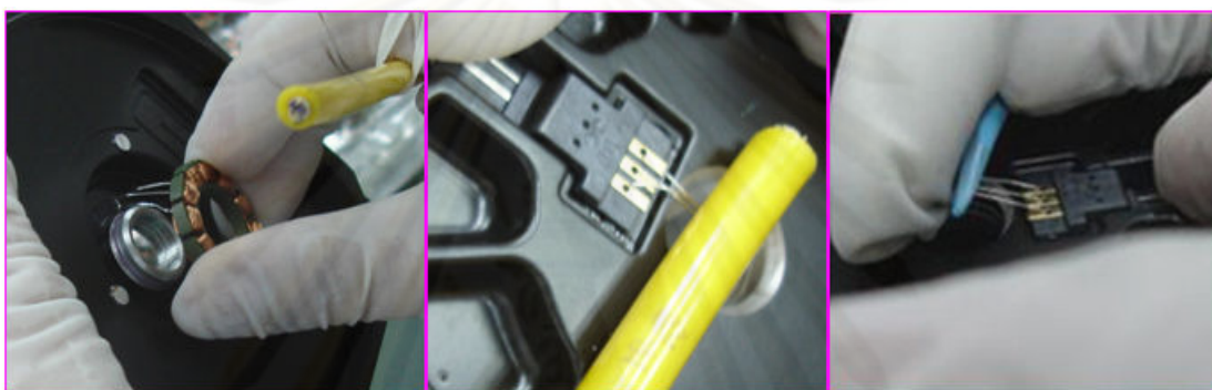
รูปที่ 5.8 การพับเส้นขดลวดก่อนการบัดกรีครั้งเดียว
