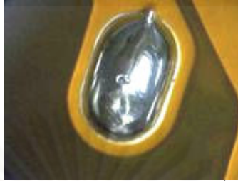
รูปที่ 3.7 การบัดกรีไม่สมบูรณ์ มีรูที่ทำให้อากาศรั่วได้
