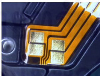
รูปที่ 3.10 การติดแผ่น FPC ไม่ตรงตามร่อง Base
