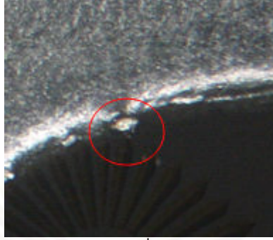
รูปที่ 5.18 ผิวน E-coat ที่ไม่สมบูรณ์ของ Base
