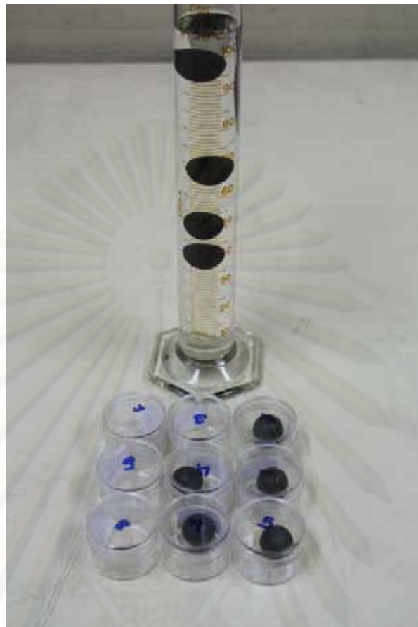
รูปที่ 3.7 ลูกลอยยางที่ผ่านการถ่วงน้ำหนักและทดสอบค่าความหนาแน่น
