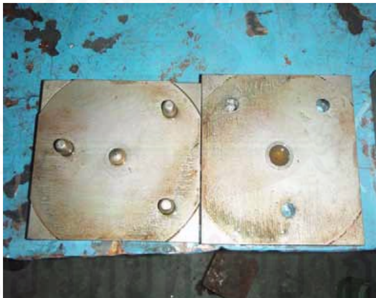
รูปที่ 3.4 แม่พิมพ์ชิ้นรูปลูกลอยเกลียวนอก
