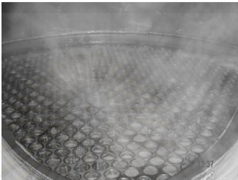
รูปที่ 1.1 การเกิดตะกรันในเครื่องระเหย
