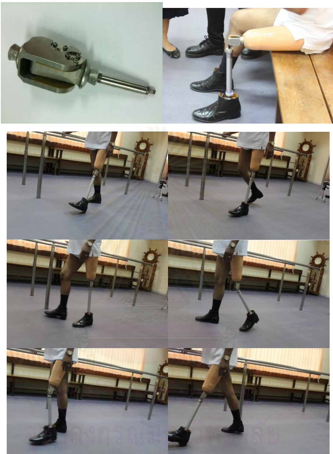
รูปที่ 4.43 กลไกข้อเข่าเทียมที่แก้ไขแล้ว (แบบ DOSL2) ที่นำไปทดสอบกับอาสาสมัครจาก โรงพยาบาลทหารผ่านศึก
