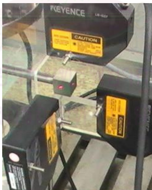
รูปที่ 5.3 ลูกบาศก์ที่ติดอยู่กับก้านที่ยื่นออกมาจากตัวออกแรงกดเพื่อใช้ในการสะท้อนของแสงเลเซอร์ในการวัดระยะยุบตัวทั้งสามแกน
