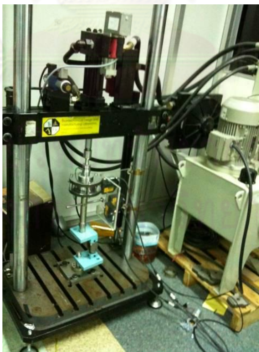
รูปที่ 2.29 เครื่องมือไฮดรอลิกส์ที่ใช้ออกแรงกดในการทดสอบกลไกข้อเท้าเทียม
