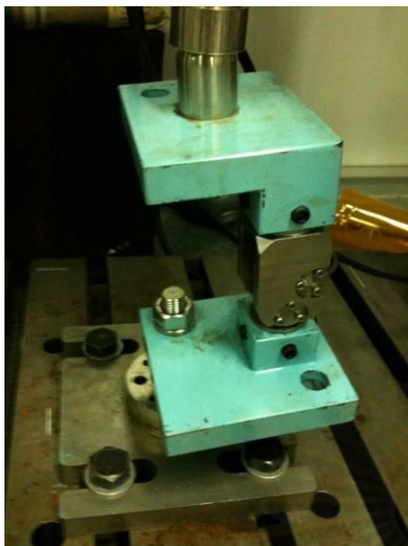
รูปที่ 2.28 กลไกข้อเท้าที่ติดกับเครื่องทดสอบและมีแนวแรงตามมาตรฐานในจังหวะ Toe off
