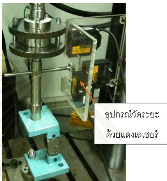
รูปที่ 5.2 อุปกรณ์วัดระยะด้วยแสงเลเซอร์ที่ติดตั้งเพื่อใช้ในการวัดค่ายุบตัวของกลไกข้อเข้าเทียม
