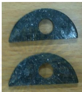
รูปที่ 4.31 แผ่นตัวหน่วงที่ทำจาก Brake pad
