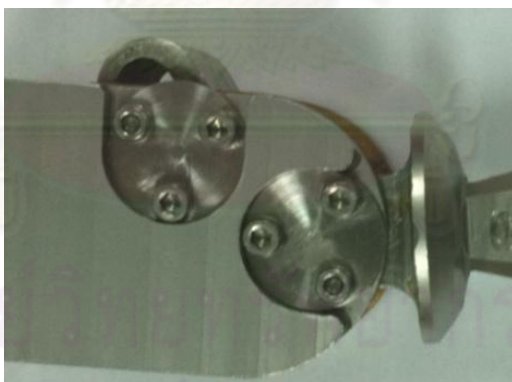
รูปที่ 4.38 การออกแบบเสาแบบใหม่ซึ่งทำให้ไม่เกิดการหลวมคลาย
