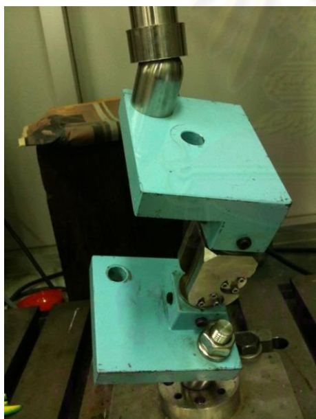
รูปที่ 2.27 กลไกข้อเข้าที่ติดกับเครื่องทดสอบและมีแนวแรงตามมาตรฐานในจังหวะ Heel strike
