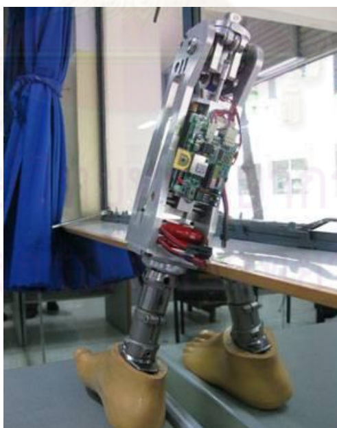
รูปที่ 2.20 ขาเทียมแบบปรับอัตราหน่วงซึ่งควบคุมด้วยระบบอิเล็กทรอนิกส์ [8]
