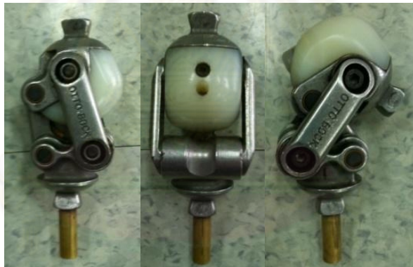
รูปที่ 1.1 กลไกข้อเข่าแบบหลายแกนหมุนที่ปัจจุบันนำเข้ามาจากต่างประเทศ [3]
