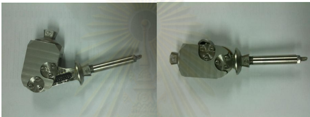
รูปที่ 4.37 กลไกข้อเข้าเทียมที่ประกอบและใส่สปริงที่มีค่าคงตัวเหมาะสมแล้ว
