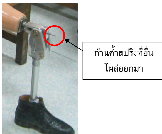
รูปที่ 3.16 กลไกข้อเท้าเทียมขณะอยู่ในท่านั่ง
