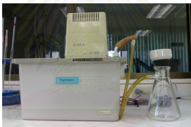
รูปที่ ก 4 เครื่องกรองสุญญากาศที่ใช้ทดสอบหาปริมาณสลัดจ์
