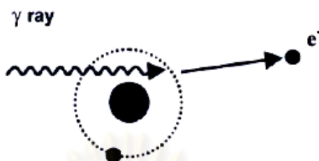
รูปที่ 2.10 แสดงปฏิกริยาโฟโตอิเล็กทริก (Photoelectric effect)
