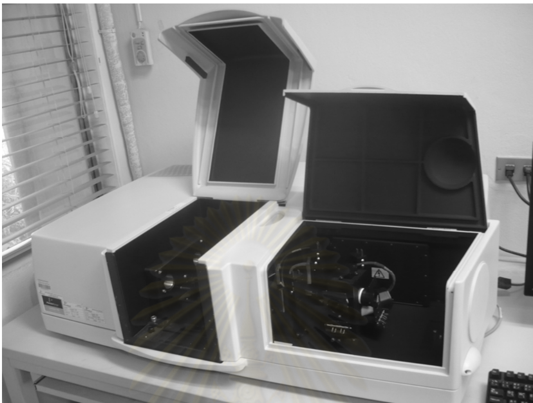
รูปที่ 3.7 เครื่อง UV-VIS-NIR spectrophotometer ของ Perkin Elmer รุ่น Lambda 750
