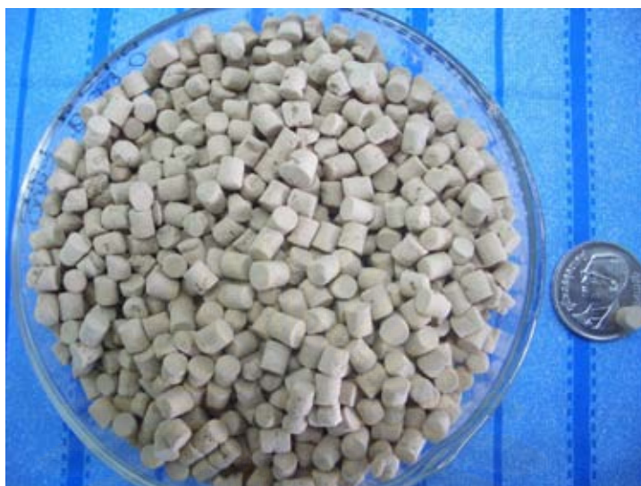
รูปที่ 4.17 ซีโอไลต์สังเคราะห์ที่ผ่านการขึ้นรูป ขนาดเส้นผ่านศูนย์กลาง 3 มิลลิเมตร
