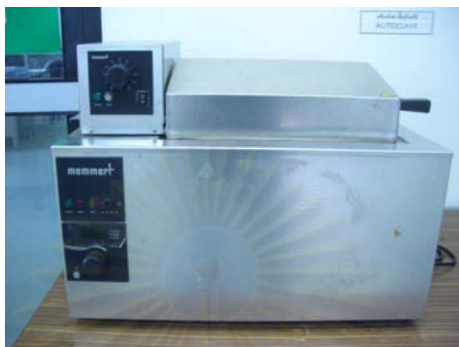
รูปที่ 3.1 เครื่อง Shaker water bath สำหรับทำปฏิกิริยาในการสังเคราะห์ซีโอไลต์
