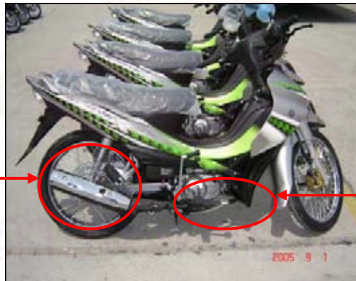
รูปที่ 3.4 แสดงชิ้นส่วน Protector Muffler และ Exhaust Pipe
