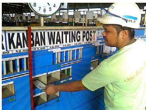
รูปที่ 5.2 การใช้งานเครื่องมือควบคุมเวลาหยิบและจัดเตรียมสินค้า
