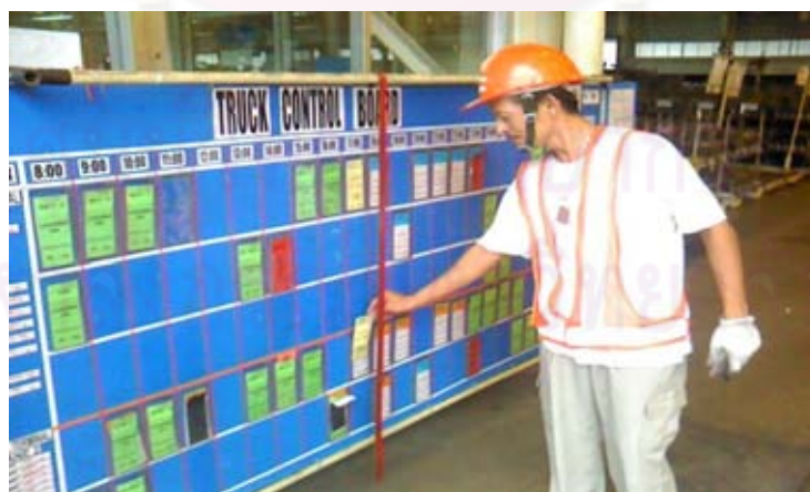
รูปที่ 5.16 การใช้งานเครื่องมือควบคุมเวลาการจัดส่งสินค้า โรงงานกรณีศึกษา
