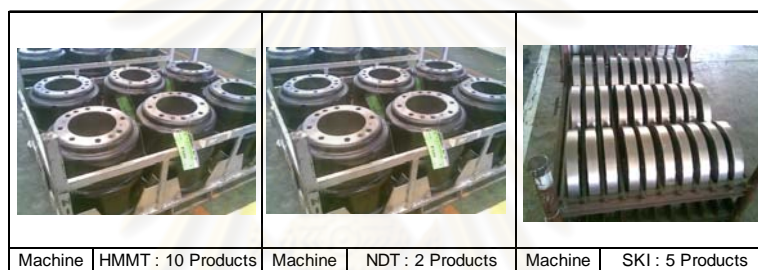
รูปภาพ ตัวอย่างสิ้นค้างานกลึงที่จัดเก็บในรูปชิ้นงานเปล่า
