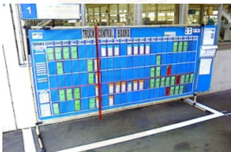
รูปที่ 5.15 ตัวอย่างเครื่องมือแสดงสถานะขั้นตอนการยกสินค้าขึ้นรถขนส่ง โรงงานกรณีศึกษา
