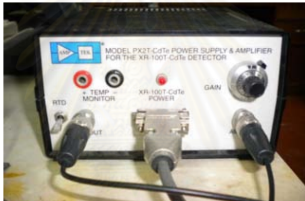
รูปที่ 3.4 อุปกรณ์จ่ายไฟฟ้าศักดาสูงและภาคขยาย/ปรับแต่งสัญญาณ สำหรับหัววัดรังสี CdTe
