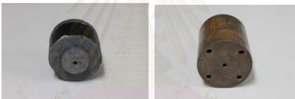
รูปที่ 3.7 ตะกั่วบังค้ำลำรังสีแกมมา และกำบังรังสีแกมมา
