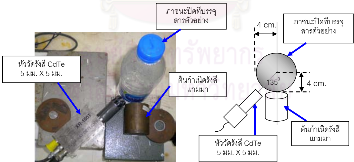
รูปที่ 3.8 ลักษณะการจัดระบบวัดรังสีแกมมาทะลุผ่าน
