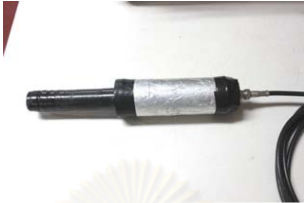
รูปที่ 3.3 หัววัดนิวตรอนชนิด Li loaded glass scintillator รุ่น NE905
