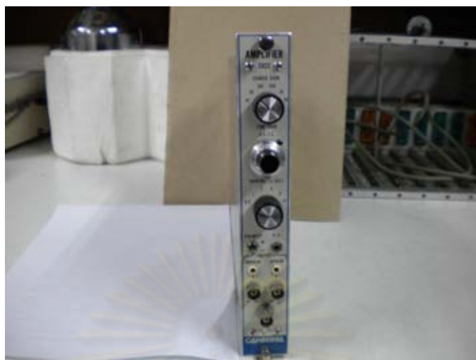
รูปที่ 3.6 อุปกรณ์ขยายสัญญาณ CANBERRA รุ่น 2022 สำหรับหัววัดนิวตรอน
