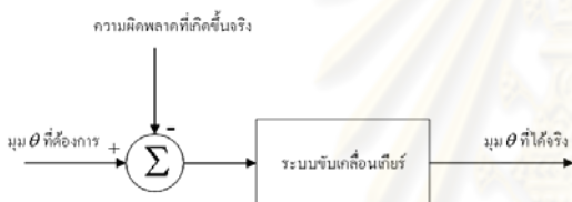
รูปที่ 4.1 วิธีการลดความผิดพลาดที่เกิดขึ้นในเกียร์ [3]
