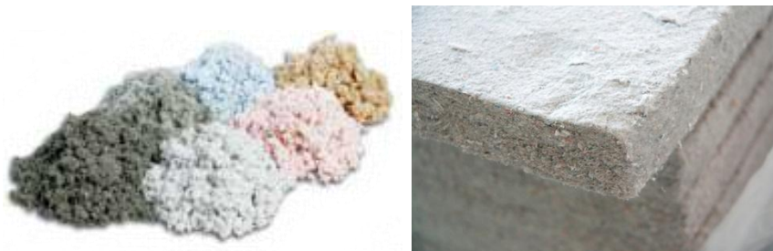
ภาพที่ 2.10 วัสดุฉนวนเยื่อกระดาษ และฉนวนเยื่อกระดาษแบบแผ่น
