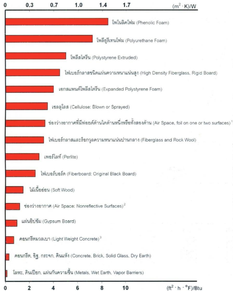
ภาพที่ 2.16 แสดงการเปรียบเทียบค่าความต้านทานความร้อน (ค่า R) ของวัสดุที่มีความหนา 1 นิ้ว (สุนทร บุญญาธิการ, 2542)
