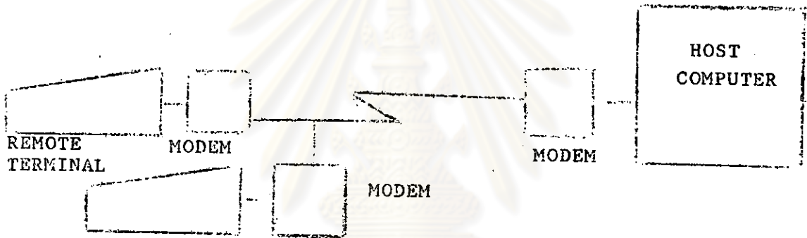
แผนภาพที่ 3.12 การตรวจจับข้อมูลโดยวิธี Wire Tapping
