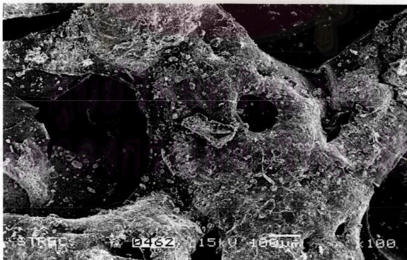
รูปที่ 4.13 ลักษณะสัณฐานวิทยาที่ กำลังขยาย 35 เท่า และ 100 เท่า ของเจลาตินที่มีถุงน่องและมาเลอิกแอนไฮไดรด์ สูตร G-10-10
