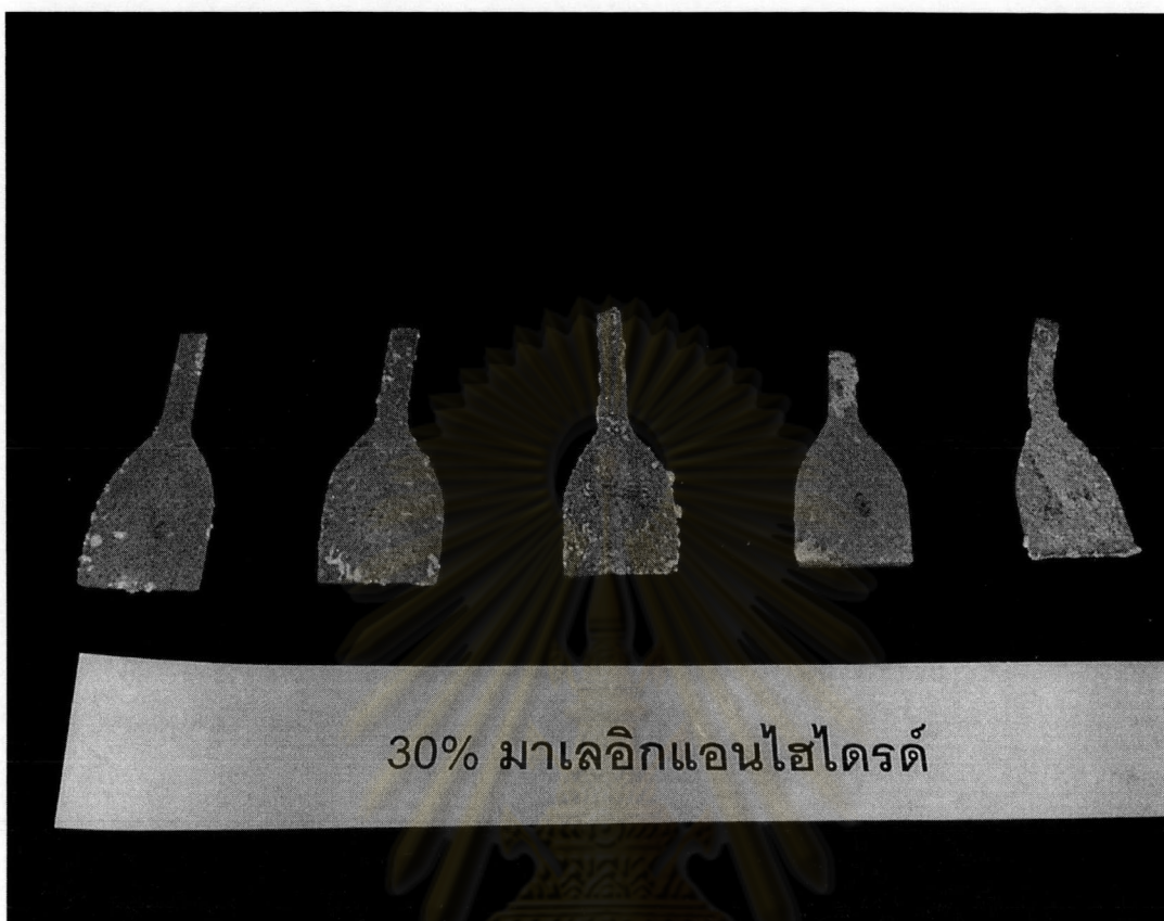
รูปที่ 4.7 ลักษณะของชิ้นงานที่เติมมาเลอิกแอนไฮไดรด์ 30 phr (G-X-30) โดยเรียงจากซ้ายไปขวา คือ สูตร G-0-30, G-5-30, G-10-30, G-15-30 และ G-20-30
