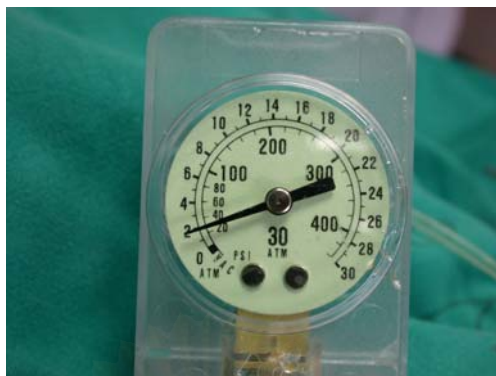
ภาพที่ 10 สามารถสังเกตแรงดันที่ใช้ห้ามเลือดได้จากหน้าปัดของ Balloon inflator จากภาพใช้แรงดันประมาณ 2 บรรยากาศ
