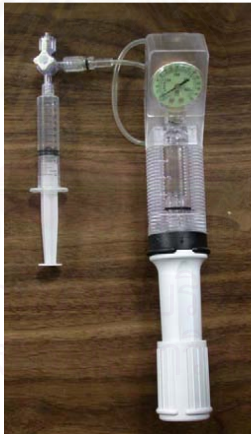
ภาพที่ 7 “จุกา-แคลมป์” (Chula-Clamp) ส่วนควบคุมแรงกดประกอบด้วย Balloon inflator ซึ่งบรรจุน้ำภายในและยึดต่อกับ Disposable Syringe ขนาด 10ml.
