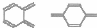
รูปที่ 2.5 แสดงโครงสร้างของ Ortho- and para- quinoid ring chromophores
