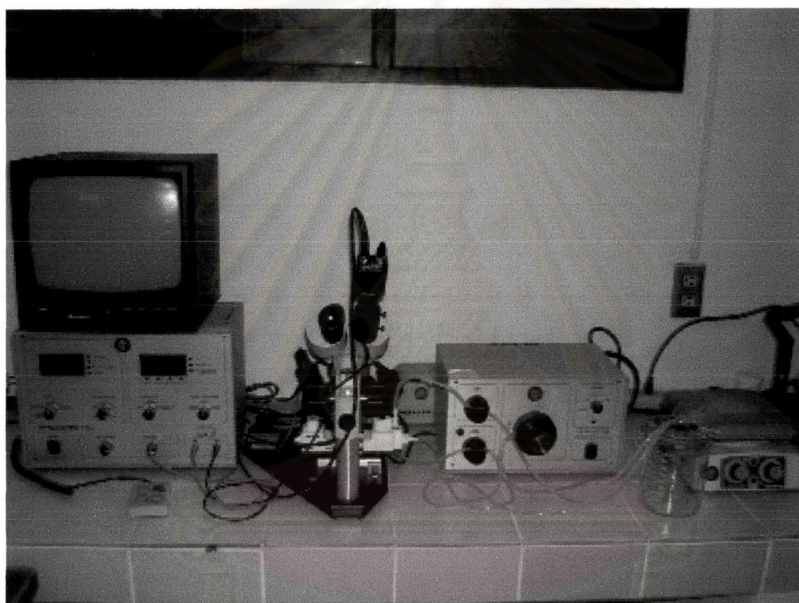
รูปที่ ก.7 เครื่องวัดค่าศักย์ไฟฟ้าที่ผิวแร่ ( Zeta Meter System )
