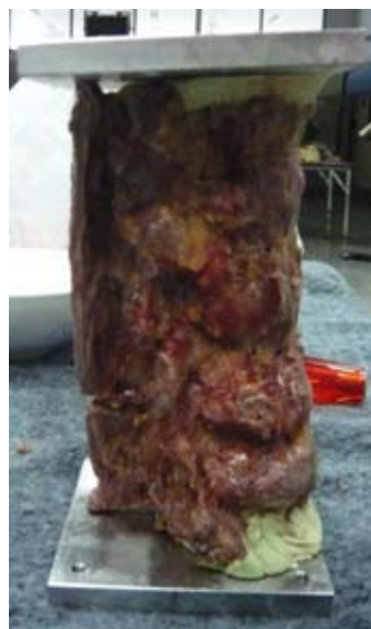
ภาพที่ 19 การยึด L1 ติดกับแผ่นเหล็กบน และ L5 ติดกับแผ่นเหล็กล่าง
