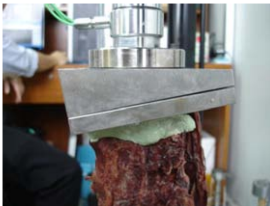
ภาพที่ 27 การทดลองโดยใส่แผ่นเหล็กที่เอียงทำมุม 10 องศาเพื่อให้เกิดการก้ม (Flexion)
