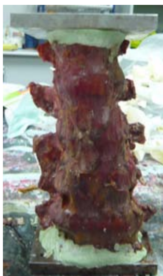
ภาพที่ 19 การยึด L1 ติดกับแผ่นเหล็กบน และ L5 ติดกับแผ่นเหล็กล่าง
