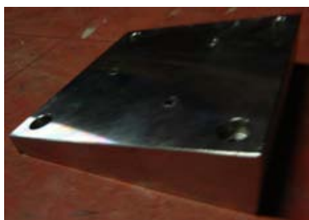
ภาพที่ 7 แผ่นเหล็กสำหรับรองก้นน้ำหนักที่เอียงทำมุม 10 องศา
