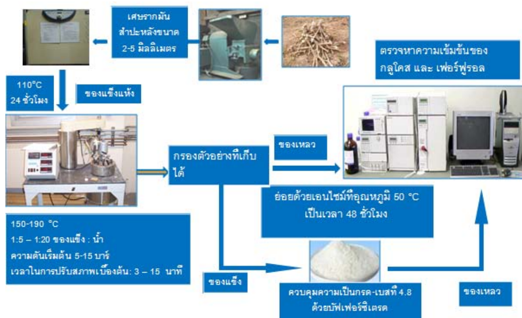
ภาพที่ 3.9 ขั้นตอนโดยรวมของการผลิตสารละลายกลูโคสจากเศษรากมันสำปะหลัง
