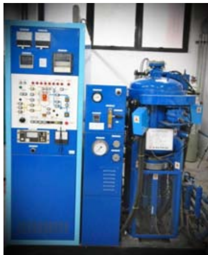
ภาพที่ 3.2 เต้าแกรไฟต์ที่ควบคุมบรรยากาศอาร์กอน
