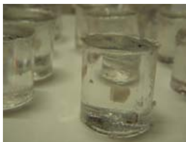
ภาพที่ 17 ชิ้นฟันตัวอย่างในแบบหล่อเรซินใส
