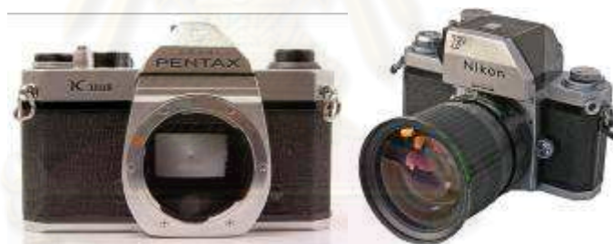
ภาพที่ 1.4 แสดงลักษณะของกล้องรีเฟล็กซ์แบบเลนส์เดี่ยว
