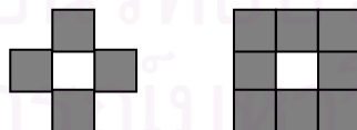
ภาพที่ 2 เซลล์รอบข้างของเซลล์ลูอาร์ ออโตมาตาจัตุรัส 2 มิติ
