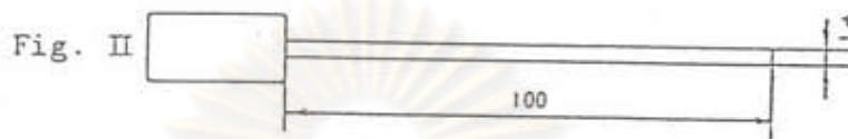
รูปที่ 6.6 Test Pin และ Push Pull Gauge ใช้ในการทดสอบอันตรายจากไฟฟ้าช็อคในการใช้งานภาวะปกติ-3
