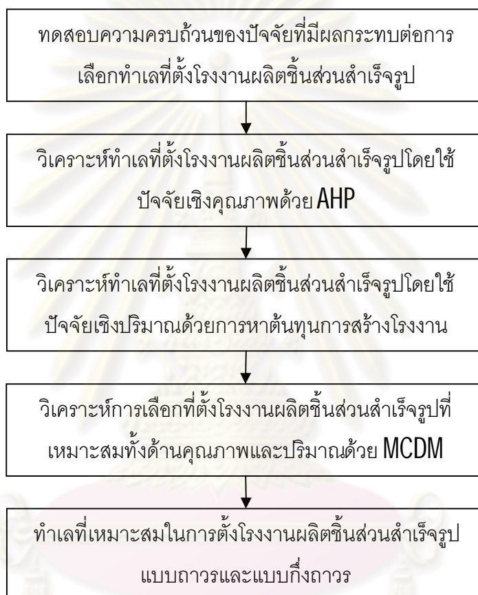
รูปที่ 3.1 การแสดงขั้นตอนการวิเคราะห์เพื่อหาที่ตั้งของโรงงานผลิตชิ้นส่วนสำเร็จรูปแบบถาวร และแบบกึ่งถาวรที่เหมาะสมทั้งด้านคุณภาพและปริมาณ
