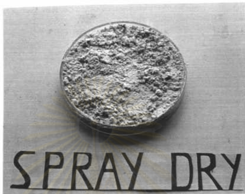
รูปที่ 4.4 ผลลพภาพที่ได้จากการทาน้ำแห้งด้วยเครื่องอบแห้งแบบพ่นกระจาย ที่อุณหภูมิ สมร้อนเข้า 180°C อุณหภูมิสมร้อนออก 100°C อัตราการป้อน 0.5 ลิตร/ชั่วโมง
