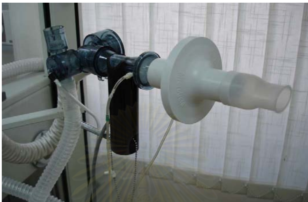
ภาพที่ 3 เครื่องตรวจวัดสมรรถภาพปอดสไปโรมิเตอร์
