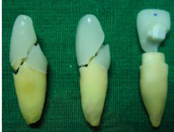
ภาพที่ 22 แสดงการแตกหักของซี่ฟันทดสอบในกลุ่มที่ 4
