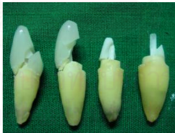
ภาพที่ 23 แสดงการแตกหักของซี่ฟันทดสอบในกลุ่มที่ 5
