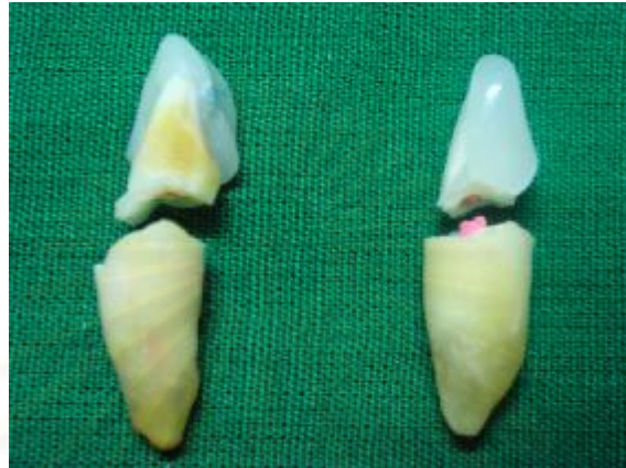
ภาพที่ 19 แสดงการแตกหักของซี่ฟันทดสอบในกลุ่มที่ 1
